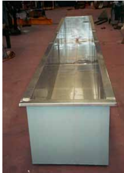
Fig.6 Serbatoio in acciaio inox con camicia riscaldante.
