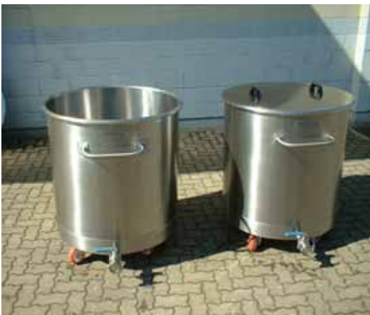
Fig.9 Serbatoi carrellati in acciaio inox da 1000 litri.
