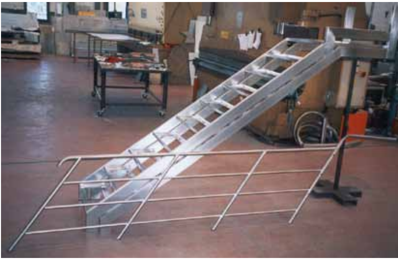
Fig.2 Scala con corrimano in acciaio inox.
