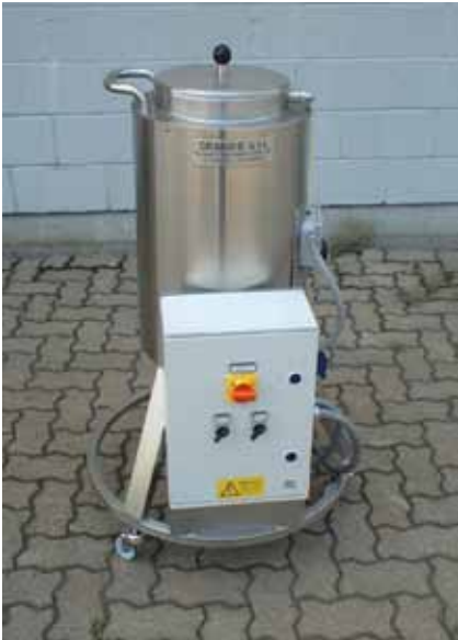
Fig.6 Serbatoio in acciaio inox con camicia riscaldante.
