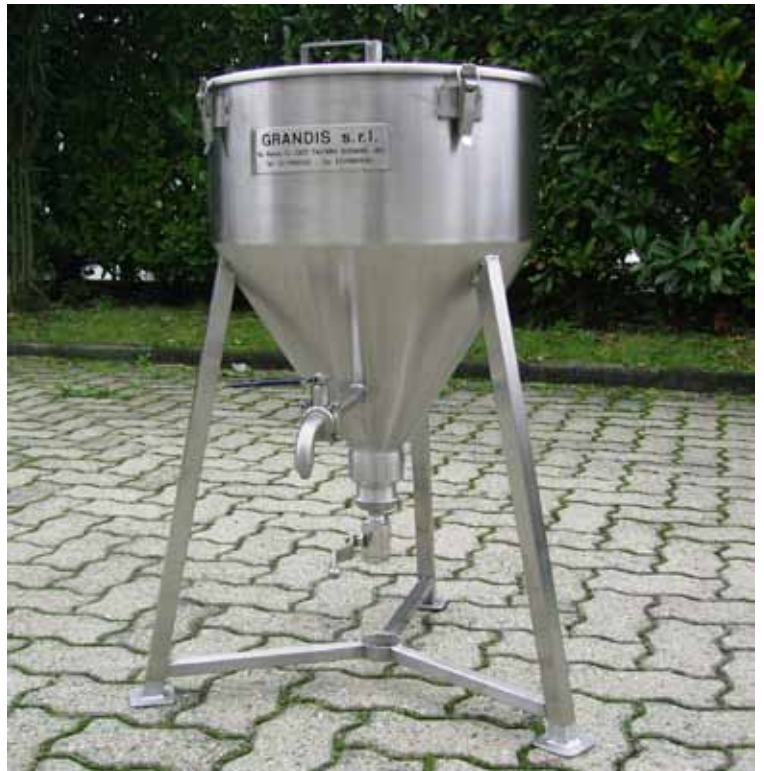
Fig.3 Serbatoio con fondo conico e valvola di scarico.
