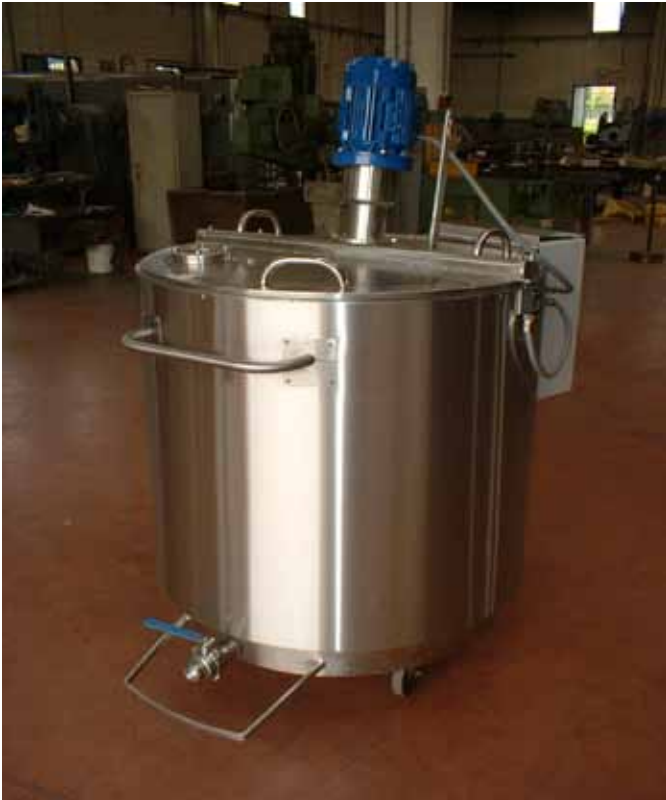
Fig.4 Serbatoio in acciaio inox con agitatore elettrico.
