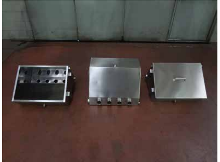
Fig.2 Tramogge a forma tronco-piramidale con attacchi clamp e camicia riscaldante.
