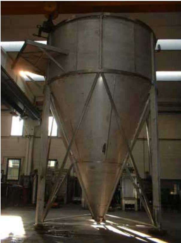
Fig.3 Decantatore in acciaio inox da 20.000 litri.
