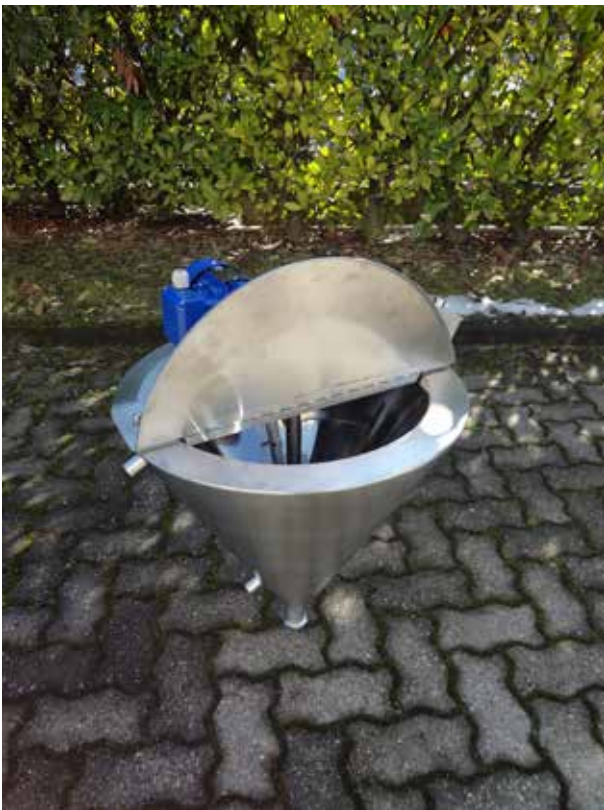
Fig.5 Tramoggia con raschiatore e camicia riscaldante.
