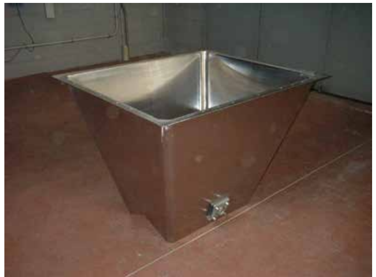
Fig.6 Tramoggia a forma tronco-piramidale.
